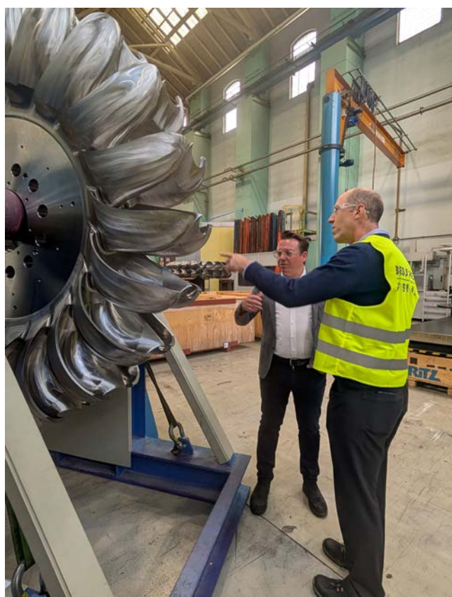
Greg Payne observe une roue/turbine Pelton utilisée pour la production d'énergie hydroélectrique aux sièges administratifs d'Andritz à Graz, en Autriche.
