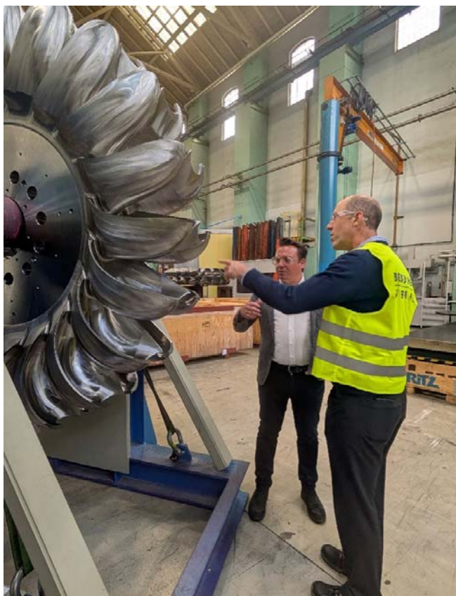
Roue/turbine Pelton utilisée pour la production d'énergie hydroélectrique.
