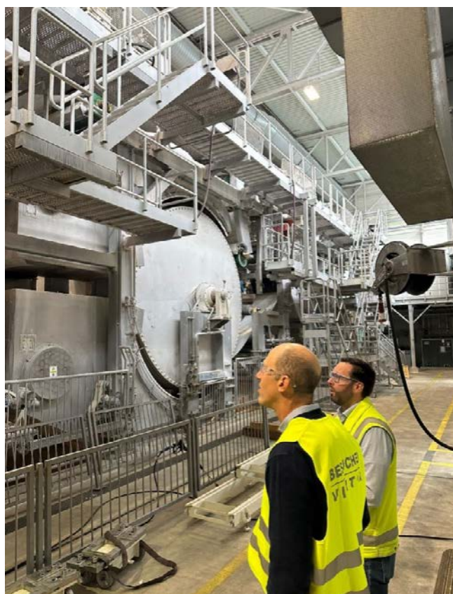
Machine de production de papier au Centre d'application et d'innovation des papiers-mouchoirs.
